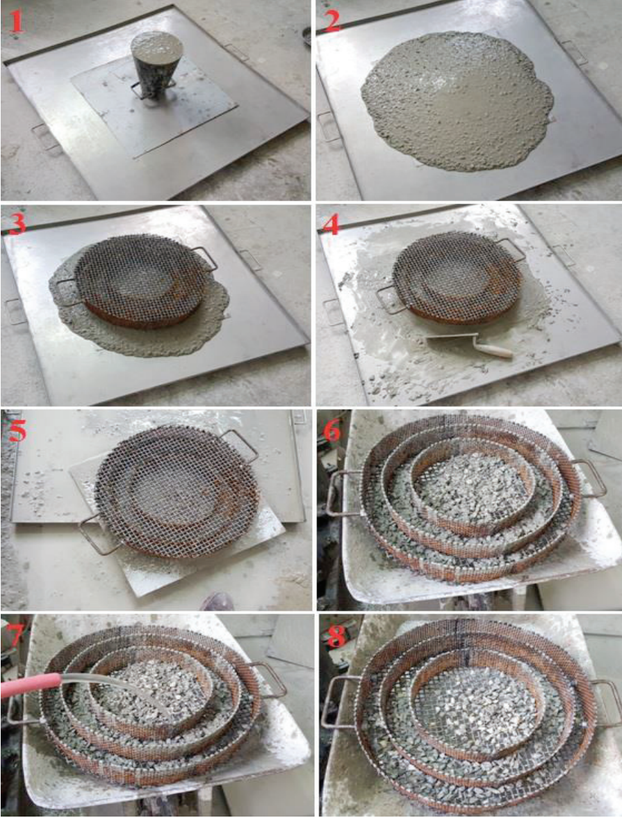
Şekil 2. 3 bölmeli eleğin kullanım detayları
