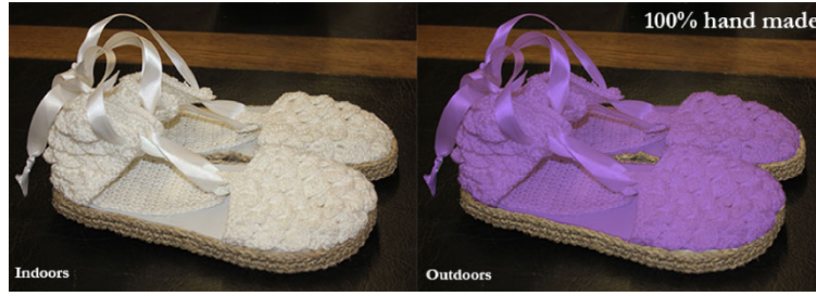
Şekil 3. Fotokromik iplik ile örülmüş el yapımı sandaletin UV ışık ile işlem öncesi (solda) ve sonrası (sağda) görüntüleri [10].
