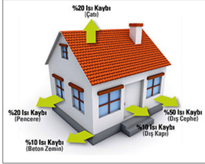
Şekil 2. Binalarda meydana gelen ısı kayıpları
